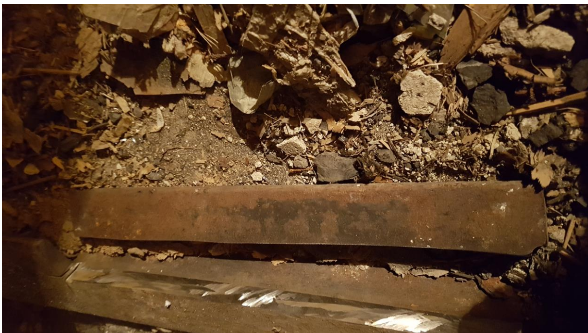
Fot. 21 Pobrany zgodnie z normą [14] odcinek górnej półki dwuteowej belki nośnej stropu poddasza przeznaczony do badań laboratoryjnych wytrzymałości i spawalności stali
