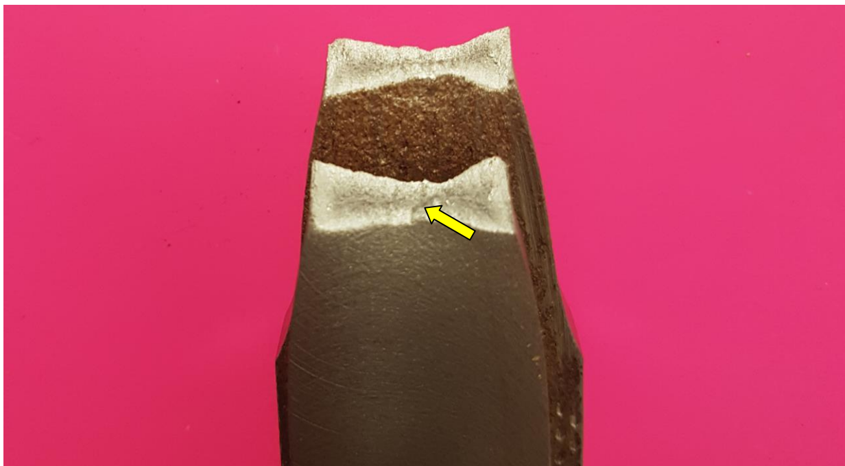
Fot. 24 Zerwana próbka – widoczna skośna wada strukturalna naprzeciwko ostrza żółtej strzałki
