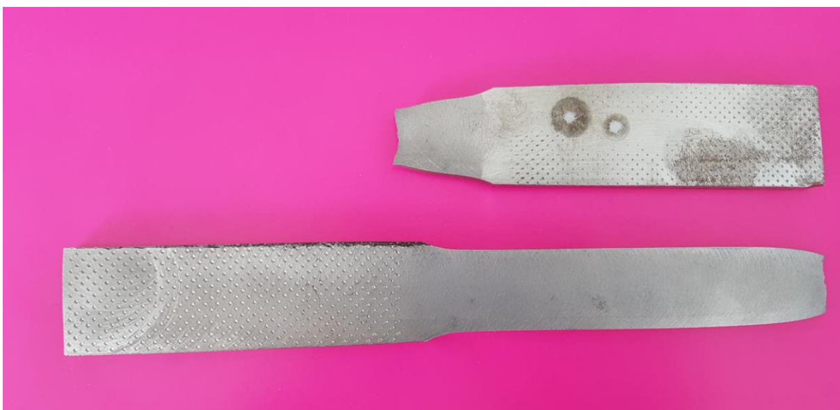
Fot. 25 Zerwana próbka – widoczna ślady po wiązce elektronowej ze spektrometru
