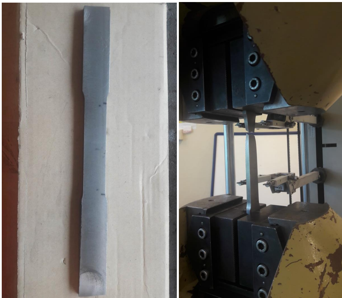
Fot. 22 Próbka do badań wytrzymałościowych przygotowana zgodnie z normą [14]
